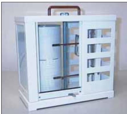
Strumento per la registrazione su carta diagrammata della temperatura e dell'umidità relativa; utilizzato sia per impieghi meteorologici che industriali, è adatto in tutti quei casi dove sia necessario controllare le condizioni di benessere ambientale.
